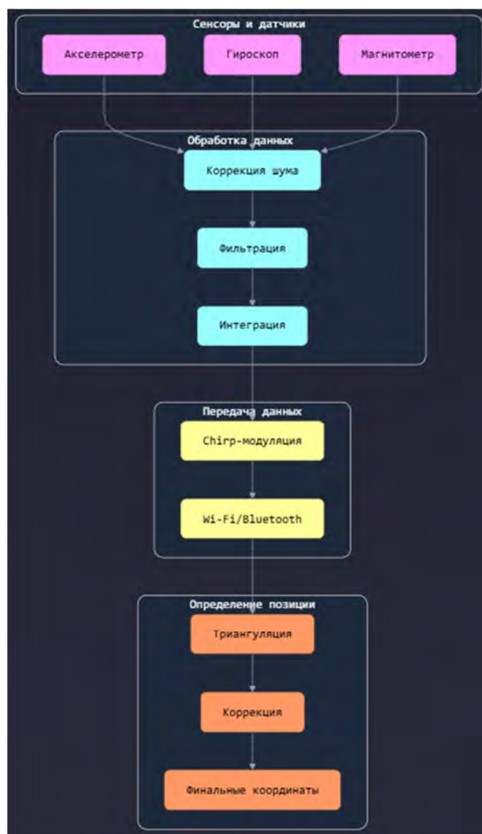
Рис. Принцип работы трекера
