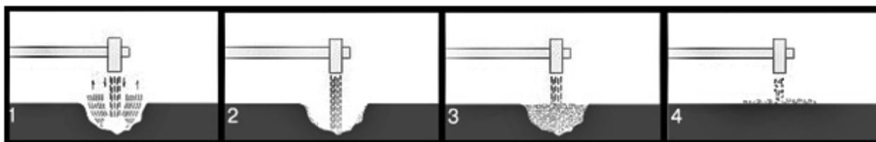
Рис. Технология ямочного ремонта струйно-инъекционным методом
