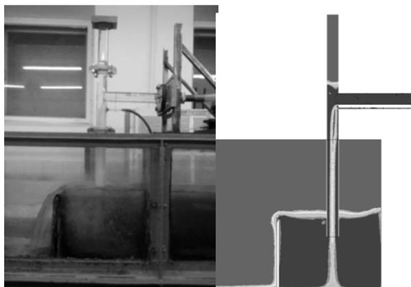
Рис. 1. Моделирование работы камеры гашения напора: а) – на физической модели; б) – на математической модели в ANSYS CFX
