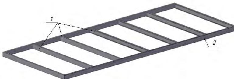
Рис. 1. Каркас кровельной панели из ЛСТК
