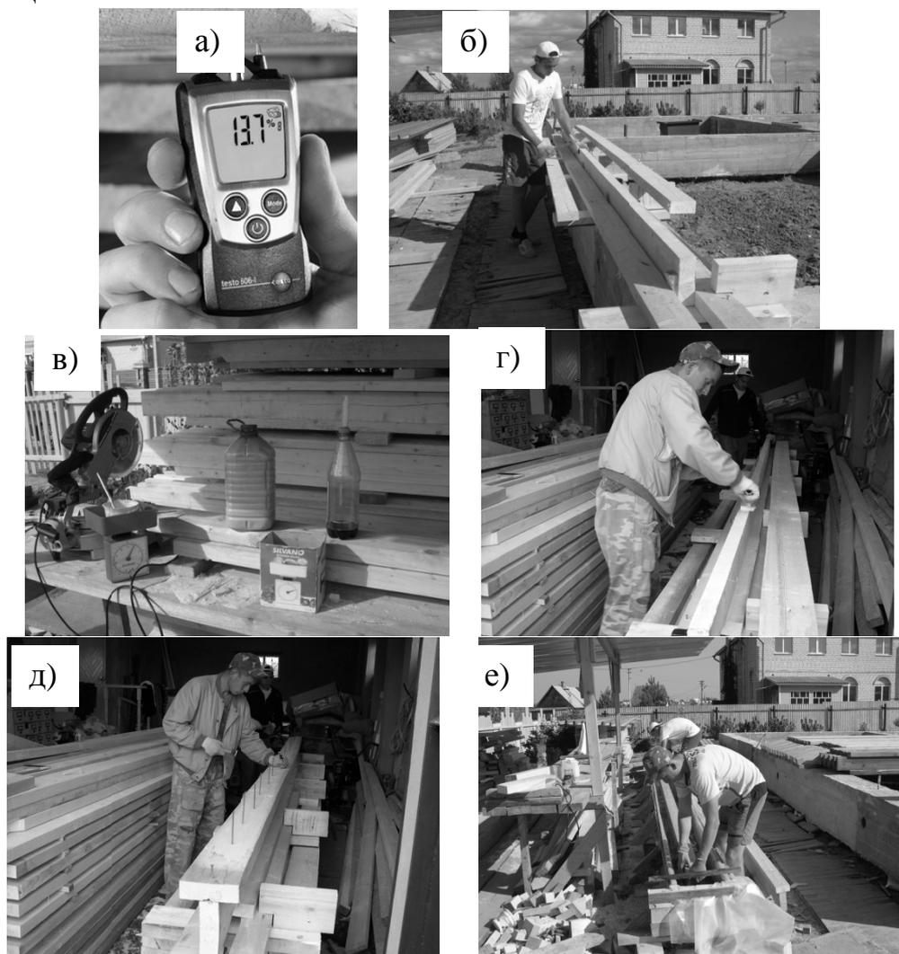
Рис. 1. Технологические операции по изготовлению балок построечного типа:
