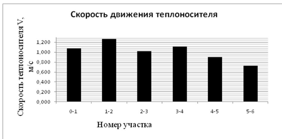
Рис. Скорость движения теплоносителя на различных участках тепловой сети
