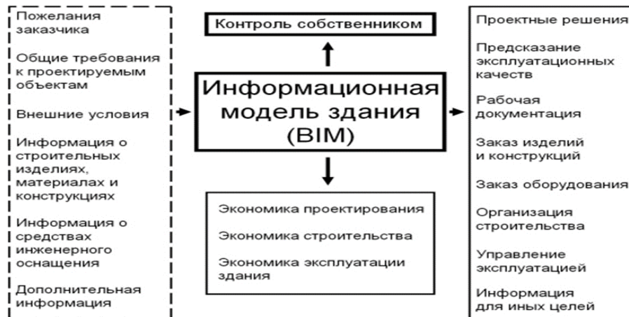
Рис. 1. Схема функционирования BIM-технологии
