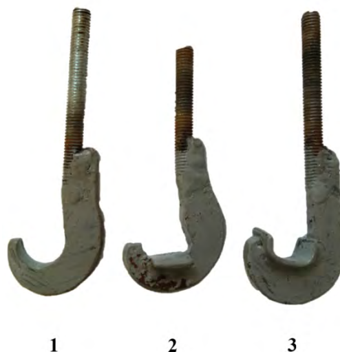
Рис. 2. Инденторы: 1 – для определения остаточной склеиваемости витков поврежденной обмотки между собой; 2 – для определения силы выдергивания поврежденной обмотки; 3 – для определения остаточной твердости лобовой части обмотки
