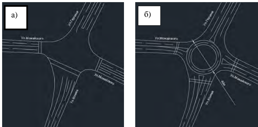
Рис. Схема на пересечении улиц Конева – Можайского – Герцена: а) существующая; б) предлагаемая кольцевая
