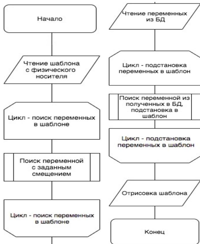
Рис. Блок-схема разработанного алгоритма
