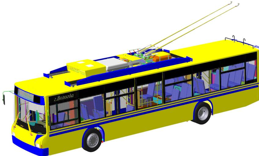
*Рис. Пример использования САD-технологий в 3D-проектировании современного низкопольного троллейбуса*
