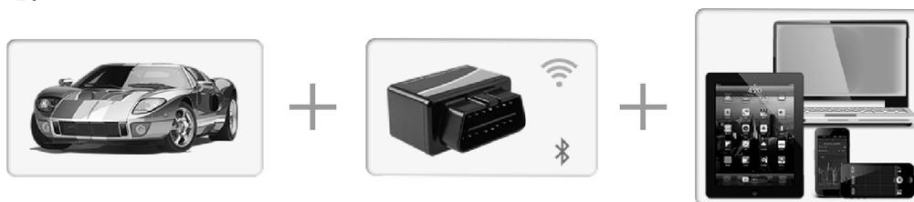
Рис. 1. Взаимодействие с ЭБУ автомобиля через OBDII
